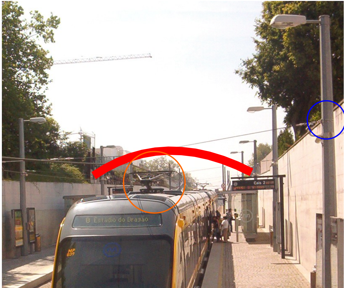
Simulação da cobertura com catenária rebaixada
